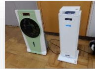
安定型次亜塩素酸ナトリウムミスト除菌器と 紫外線空気除菌器
